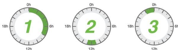
拥有3个可定义设置的时段，用户可以在00:00~23:59范围内自由设置市电充电/带载时段，在用户设置的时间段内，若有光伏能量输出，将会优先利用光伏能量，若无光伏能量输出或者光伏能量不足时，将会启用市电作为补充。
