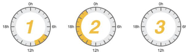
拥有3个可定义设置的时段，用户可以在00:00~23:59范围内自由设置电池放电时段，在用户设置的时间段内，逆变器将优先进行电池逆变来带载，若电池电量不足，逆变器将会自动切换至市电，确保负载稳定运行。
